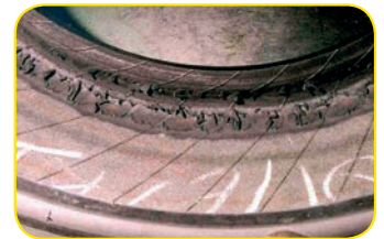
Rotura circular del revestimiento interno de la carcasa.
