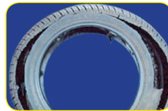
Pérdida total o parcial de la banda de rodamiento.
